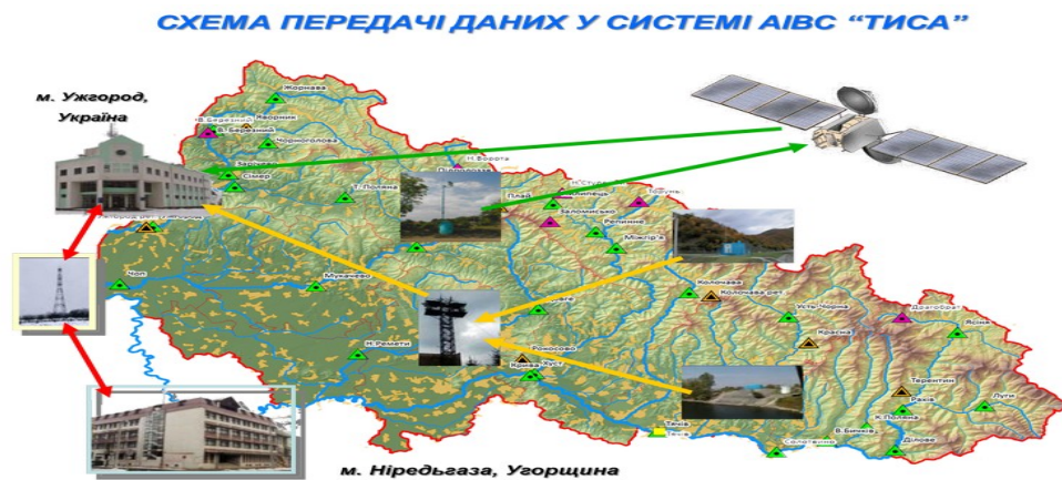
Рисунок 4.1.1 – Схема передачі даних у системі АІВС «Тиса»
